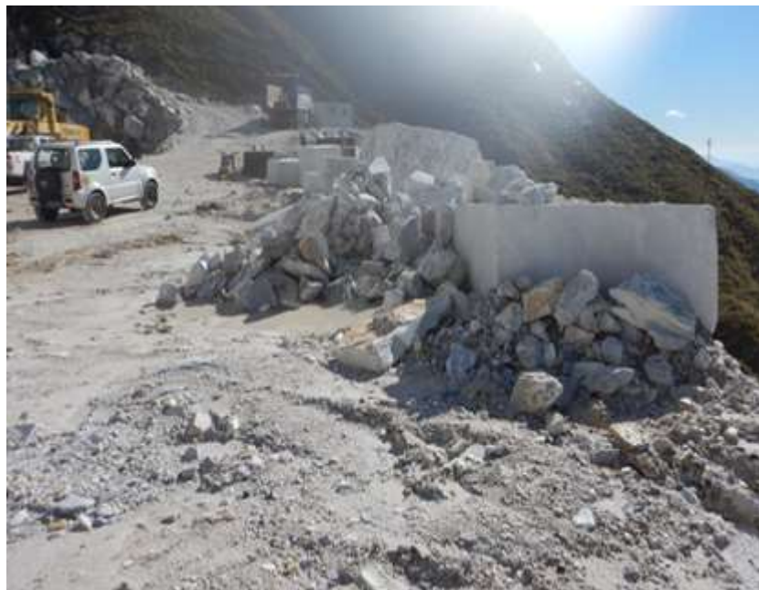
Foto 4 - Nel piazzale esterno della Tavolini A, a margine del ravaneto, sono depositati blocchi e detrito con strati di marmettola che possono scivolare, anche accidentalmente, nel sottostante ravaneto
