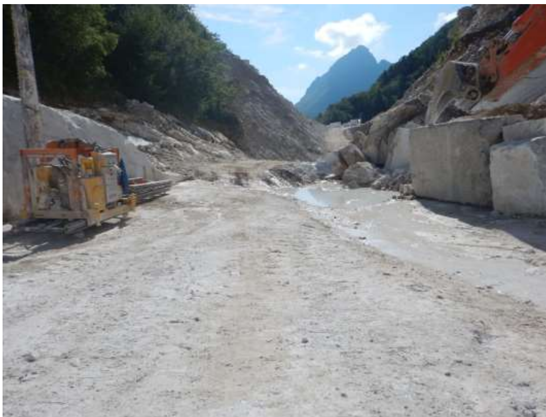
Fot. 1 – Piazzale Cava Rigo: discesa della marmettola e dell'acqua verso l'eventuale cavità carsica.
