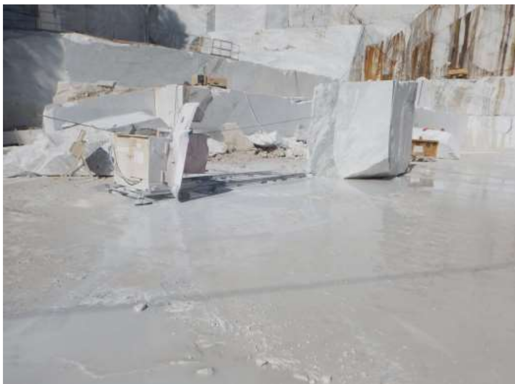
Fot. 4 – Piazzale Cava Rigo: lavorazione e riquadrature dei blocchi fatte in assenza di rieste/cordoli di contenimento delle acque.
