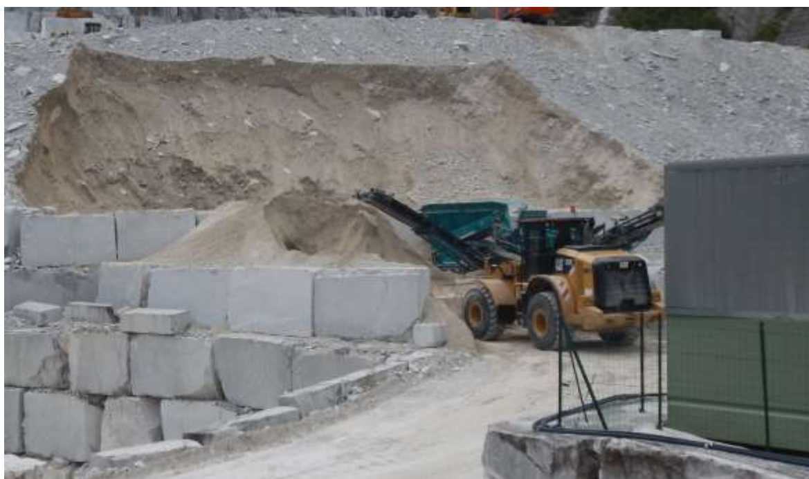
Foto 2: Presenza di vaglio mobile per la gestione del detrito in cava (foto del 01.08.2025)
