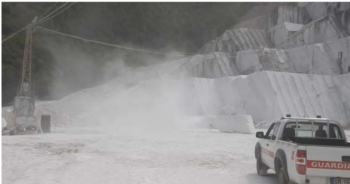
Foto 1: Sollevamento di polveri durante taglio a secco (foto del 01.08.2025)
