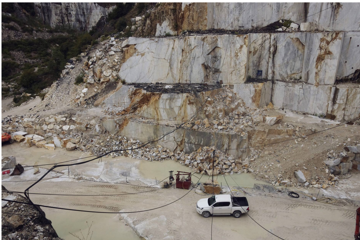
Panoramica fronti W oltre FA con evidente assenza o comunque significatività del “verso”
