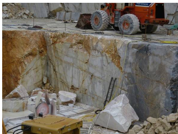
Nella foto a sx sono evidenti le tracce delle discontinuità K7 mentre in quella a dx si nota come queste non siano presenti.
