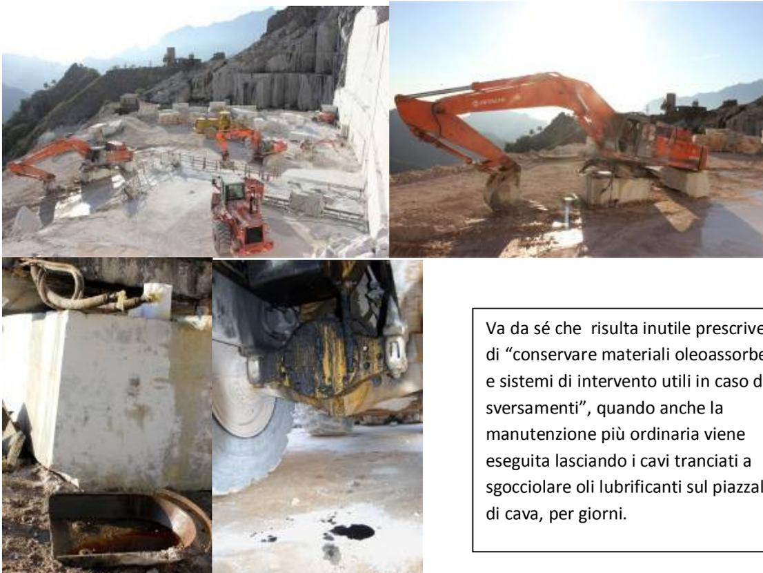
Va da sé che risulta inutile prescrivere di "conservare materiali oleoassorbenti e sistemi di intervento utili in caso di sversamenti", quando anche la manutenzione più ordinaria viene eseguita lasciando i cavi tranciati a sgocciolare oli lubrificanti sul piazzale di cava, per giorni.
