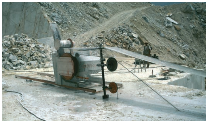
Figura 3a - Tagliatrice a filo diamantato utilizzata dalla fine degli anni '70 per il taglio al monte dei blocchi e per riquadrare gli informi sul piazzale di cava.
