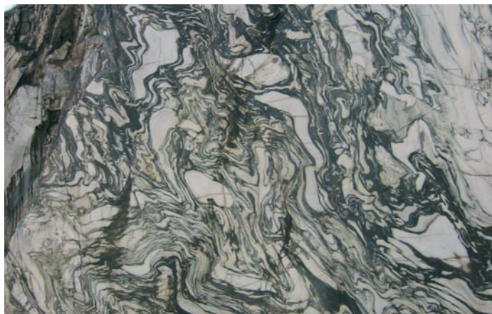
Fig. 11 Tagli di cava in marmo fantastico (Loc. Arni). La varietà merceologica fantastico è rappresentata da una metabreccia dove i diversi elementi che la compongono sono deformati in modo tale da determinare un vario e caratteristico disegno nei blocchi estratti. Le geometrie di deformazione sono frutto dell'interferenza tra diverse generazioni di pieghe e costituiscono la caratteristica principale di questa varietà merceologica.
